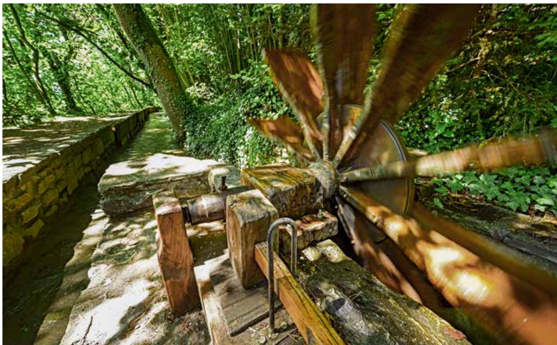
Une roue à eau permet d'entendre si le bisse fonctionne ou s'il n'y a plus d'eau qui coule.
